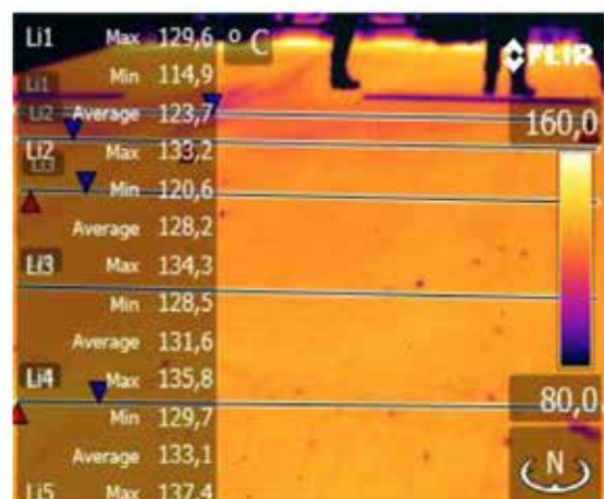
Abbildung 14: Wärmebild und Auswertungsschema einer Thermo-Mulden-Charge inkl. Abschieber ohne Beschicker
