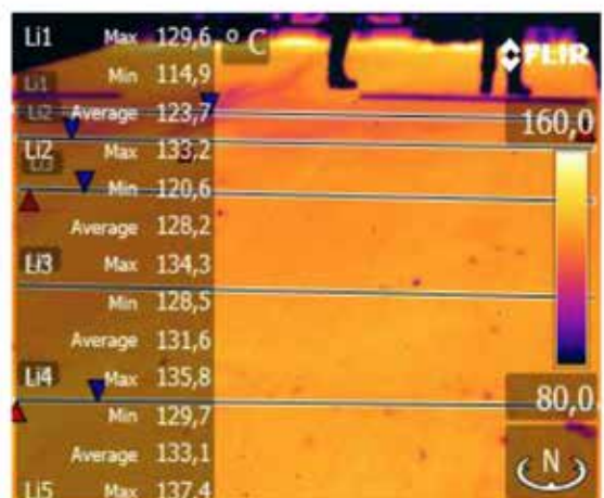
Illustration 14 : Image thermique et schéma d'exploitation d'un Thermo-Mulden-Charge avec système d'expulsion sans chargeur
