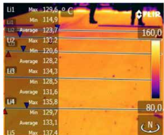
Afb. 14: Warmtebeeld en beoordeling bij een thermisch geïsoleerde laadbak met afschuifstelsel zonder feeder
