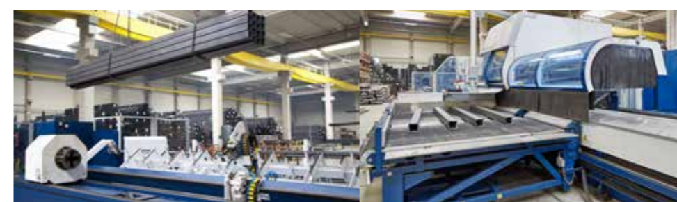
Najnowocześniejsze systemy laserowe do rur i blach umożliwiają szybką i precyzyjną obróbkę złożonych elementów.
