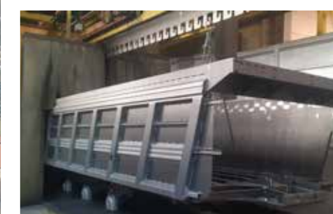
Przygotowanie lakieru poprzez śrutowanie kuleczkowe
