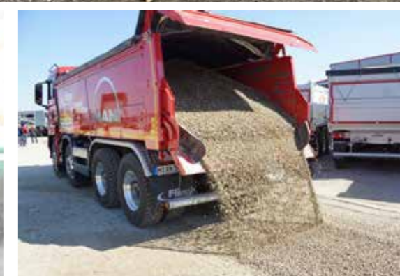
Bezpieczne „wyciąganie” podczas budowy ścieżek i dróg – Płytki centrujące o szerokości rozrzutu ok. 2 m
