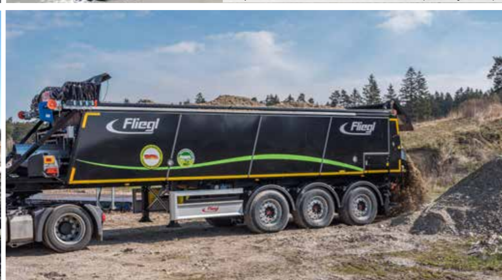
ASS 382 z osią teleskopową Dopuszczalna masa całkowita 58 ton (Skandynawia)
