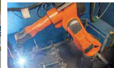
Najlepsza jakość spoin dzięki zastosowaniu robotów spawalniczych.
