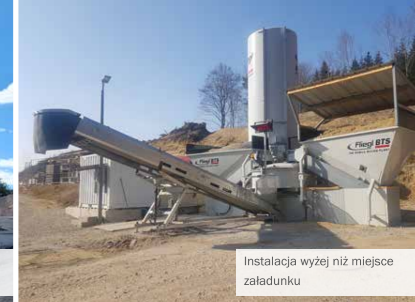
Instalacja BTS 1000 ustawiona wyżej
