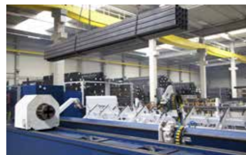
Nasze najnowocześniejsze systemy laserowe do rur i blach umożliwiają szybką i precyzyjną obróbkę nawet złożonych elementów.
