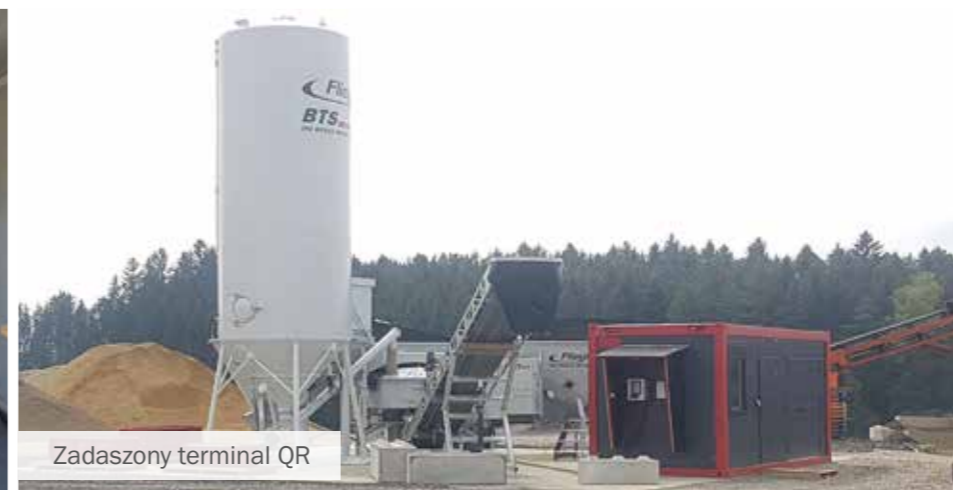
BTS 1000 3x EB, instalacja powyżej miejsca załadunku
